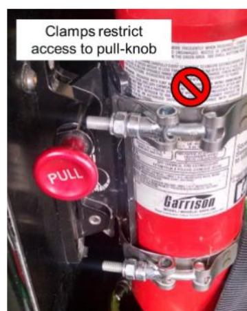
图B-61 灭火器夹头方向错误。
