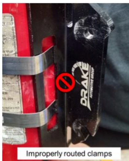
图B-62 金属卡箍错误固定示意图
